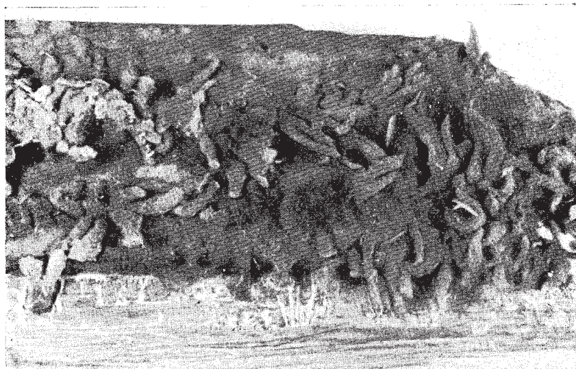
Abb. 42. Rötlichbraune Dunkelfruchtformen und Luftmyzel einer Blättlingsart ( Lenzites spec. ), an einem Blindbodenbrett aus einem teilweise durch Bomben zerstörten Haus.
