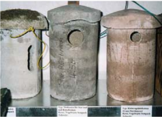
Abb. 47: Nistkästen aus Holzbeton für Baumläufer, Stare u.a. Vögel bis Meisengröße, Flugloch 32 mm Durchmesser, Hersteller um 1970 Vogelwarte Sempach (Schweiz).
